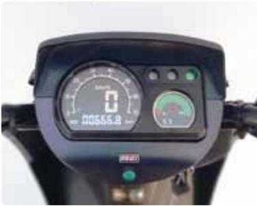
積算電流方式の液晶デジタルメーターでバッテリー残量がわかりやすい！
